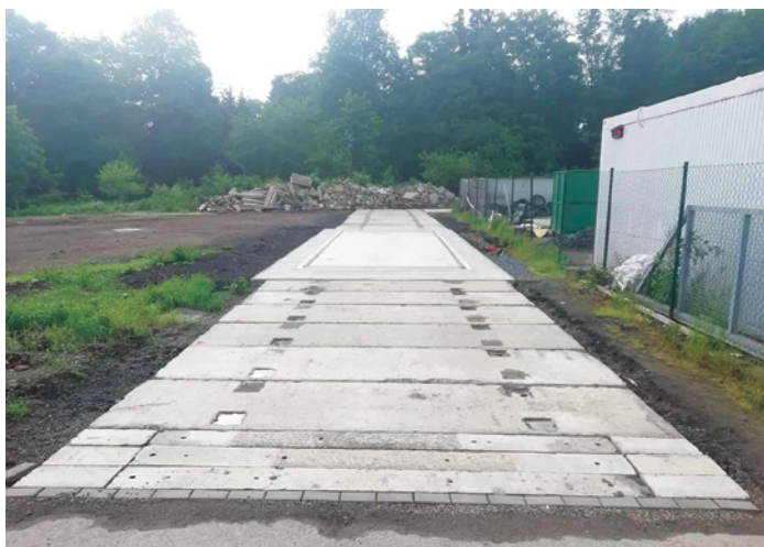
Nová váha na sběrném dvoře V dubnu byla na sběrném dvoře nainstalována mostní váha pro vážení automobilů.
